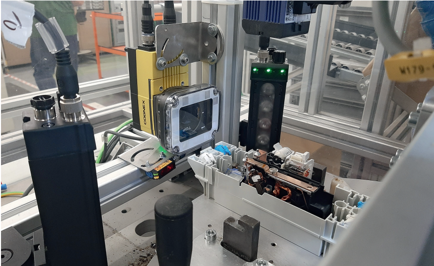
Eine intelligente Kamera In-Sight D900 von Cognex mit integrierter Deep-Learning-Technologie überprüft Lötergebnisse im Schneider-Electric-Werk Plovdiv. © Cognex
